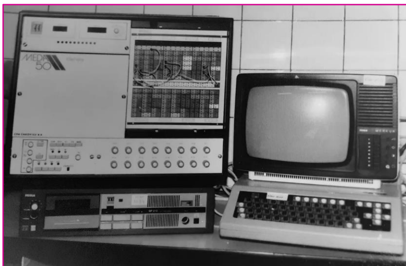
Číselný počítač IQ 151 s analogovým počítačem Meda 50, pod nímž je magnetopásková jednotka pro vstup a výstup (1988)
